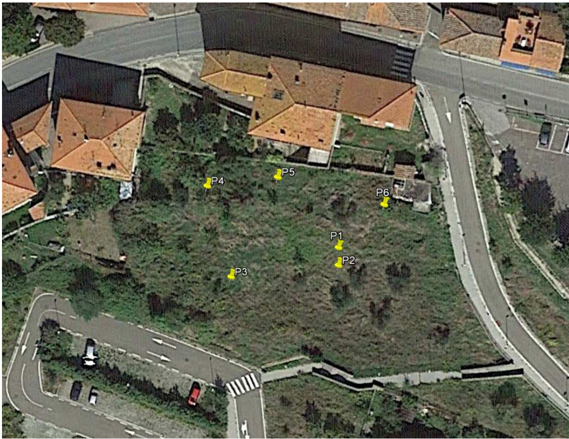
Ubicazione prove penetrometriche
